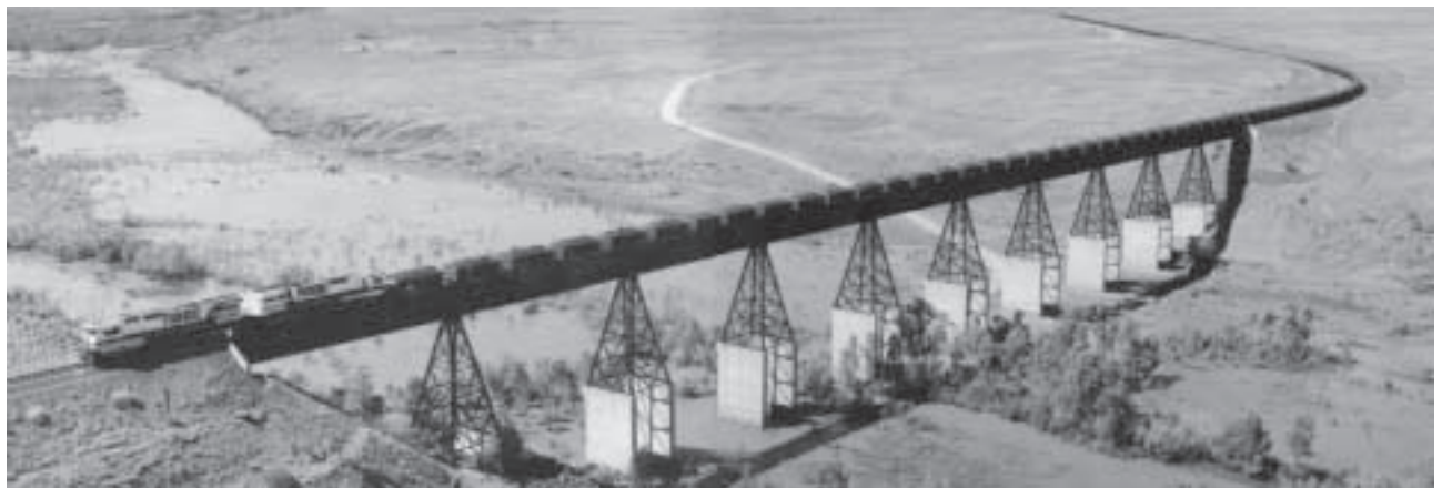
Gambar 6.10: Kereta api bijih besi sepanjang 2 km ini meluncur sejauh 200 km dari Meja J ke Pelabuhan Walcott di dekat Dampier. Di sini kereta api tersebut menyeberangi sungai Fortescue dengan muatan 200.000 ton bijih.
